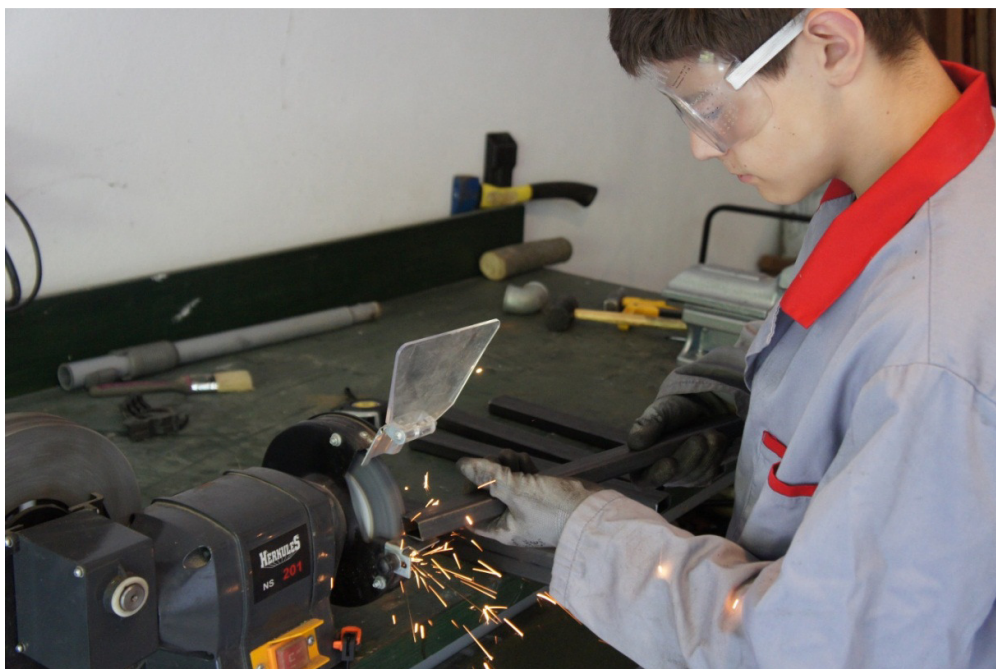
Slika 13: Brušenje ostrih robov (foto: Jože Hrovat).
