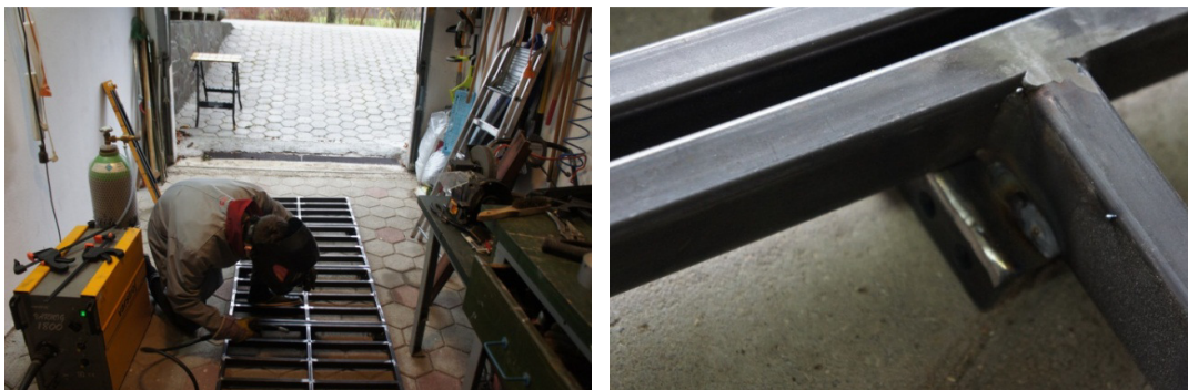
Slika 17: Levo – varjenje tečajev. Desno – pogled na privarjen tečaj. (foto: Jože Hrovat)
