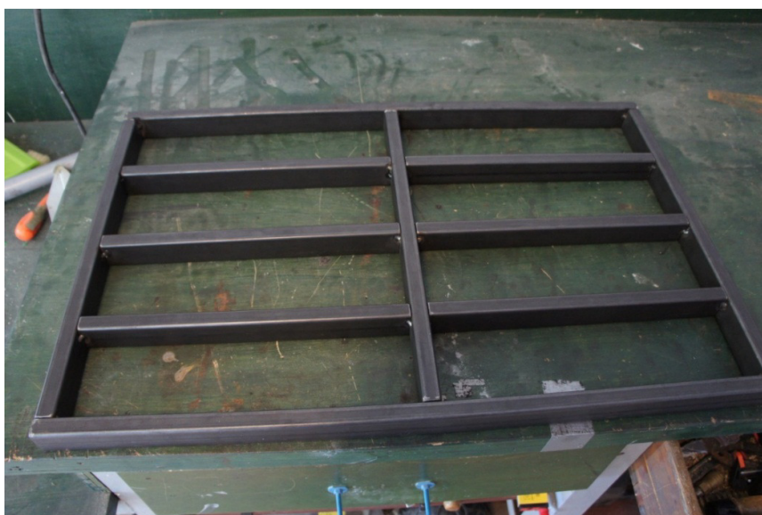
Slika 14: Zvarjeni en del modula (foto: Marko Hrovat).
