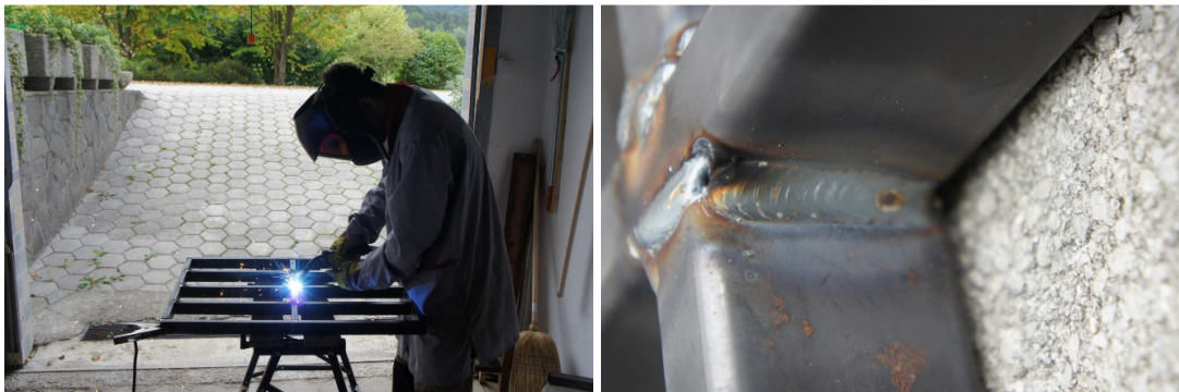
Slika 15: Levo – varjenje stičnih mest. Desno – var med stičnimi mesti. (foto: Jože Hrovat)
