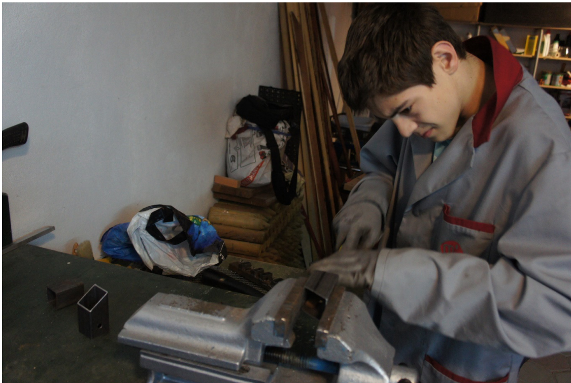
Slika 18: Piljenje vodilnega profila (foto: Jože Hrovat).
