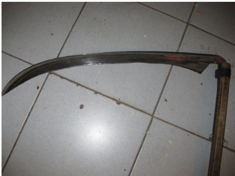
Slika 16: Ročno sklepana kosa. (foto Timotej Kreft)
